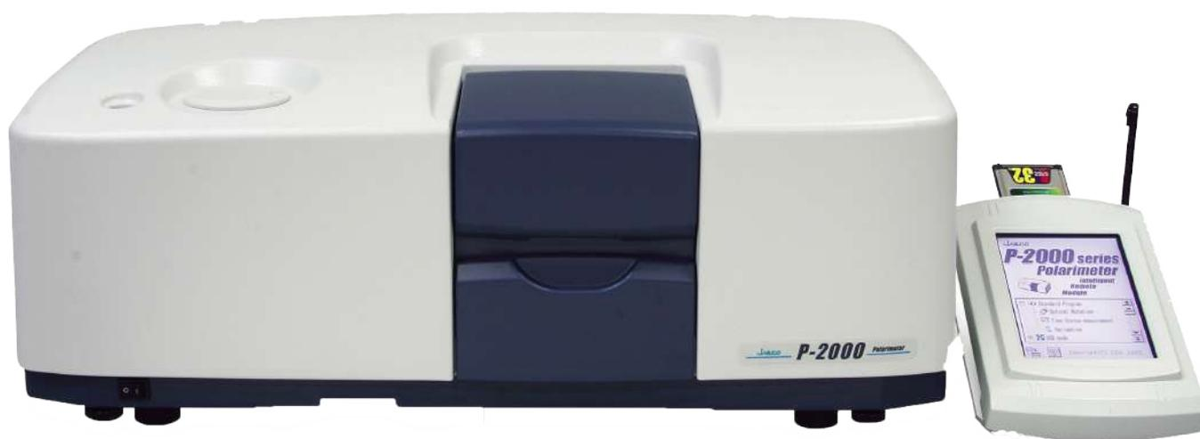
**Controle avançado de equipamento** - Duas interfaces gráficas estão disponíveis, incluindo um Módulo Remoto Inteligente (iRM) com tela colorida sensível ao toque de LCD e o software Spectra Manager II, a última e inovadora versão do software de espectroscopia de plataforma cruzada da JASCO. Versões em conformidade com a norma CFR 21 Part 11 para ambas interfaces podem ser solicitadas como opcionais.
